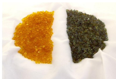
شکل ۸-۱۱- تغییر رنگ سیلیکاژل نارنجی پس از اشباع شدن از رطوبت
